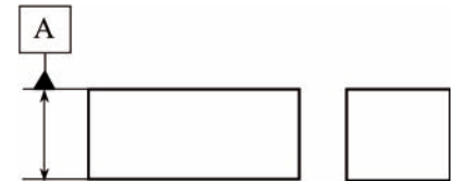
Figure 35 : élément de référence spécifiée, le biplan (deux plans parallèles en vis à vis).
